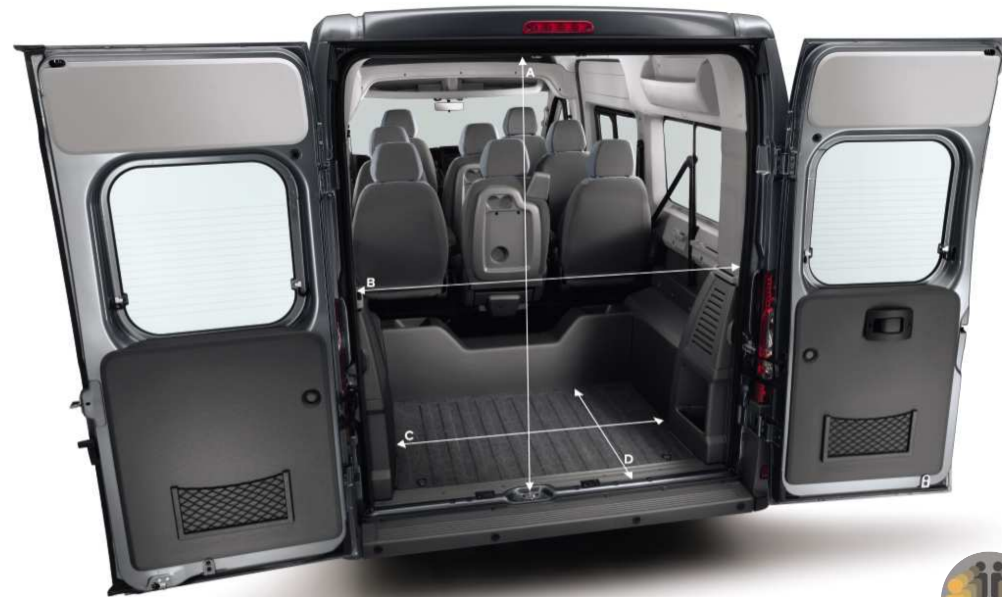
L1H1 8/9 plaatsen: A: hoogte achterdeuren in mm: 1520 - B: breedte van de laadopening in mm: 1562 - C: Ruimte tussen de wielkasten in mm: 1320 - D: Laadlengte in mm: 632. L2H2 8/9 plaatsen: A: hoogte achterdeuren in mm: 1790 - B: breedte van de laadopening in mm: 1562 - C: Ruimte tussen de wielkasten in mm: 1320 - D: Laadlengte in mm: 1082.
